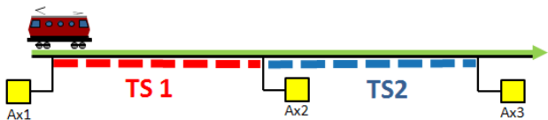
Figura 4 - Contadores de ejes para detectar la ocupación de la vía
