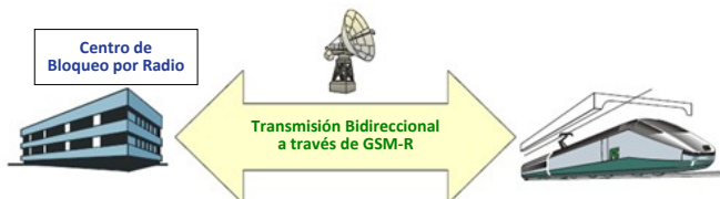
Figura 9 – Transmisión Bidireccional a Través de GSM-R
